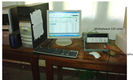
Figure 2.6: Photo du multiplexeur avec les thermocouples + PC pour le traitement des données
